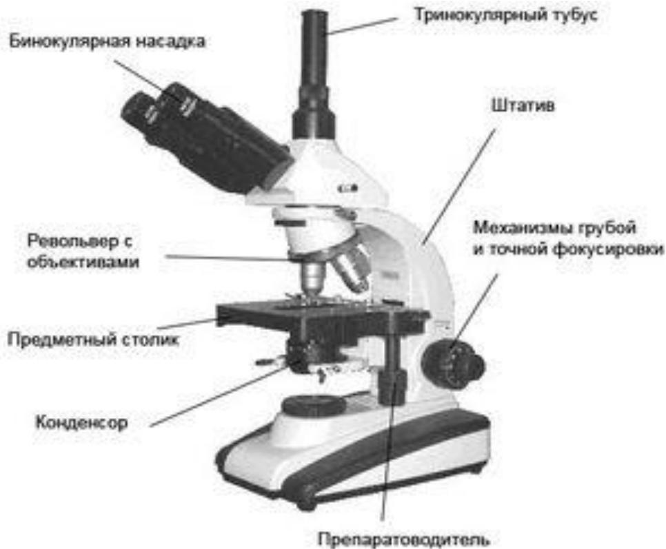
Оптическая часть представлена объективами, окулярами и осветительной системой, которая в свою очередь состоит из расположенных под предметным столиком конденсора Аббе и встроенного осветителя с низковольтной лампой накаливания и трансформатором. Объективы ввинчиваются в револьвер, а соответствующий окуляр, через который наблюдают изображение, устанавливают с противоположной стороны тубуса.
